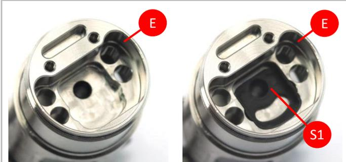
Der Isolator Pluspol [S-1] wird in die Aussparung im Deck [E] gelegt.
