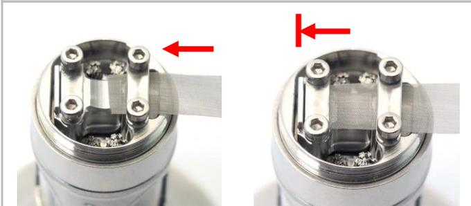
Schieben Sie einen Mesh-Streifen von außen unter die Klemme [H] vom Deck [E], und führen diesen bis zum Anschlag hinter die Klemme [H] vom Pluspol [F].
