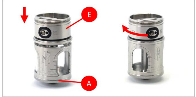
Das Deck [E] wird nun aufgesetzt und mit der Basis [A] verschraubt.
