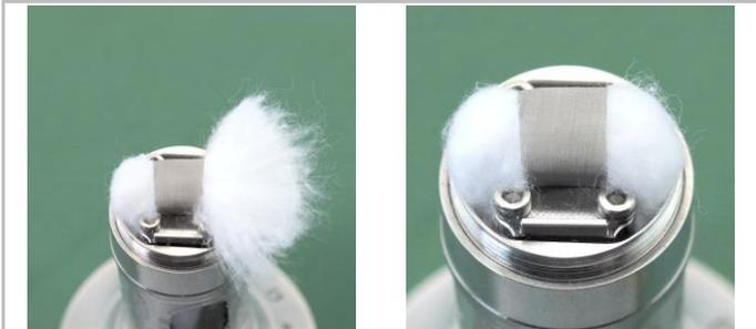
Die Enden der Watte werden nun im Bogen in die Taschen des Decks [E] auf die Dichte gelegt.
