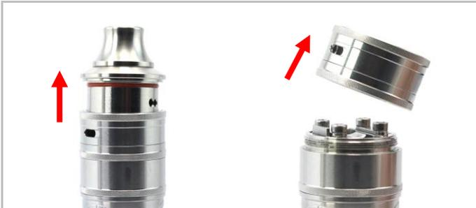
Zunächst wird die Top Cap [L] entfernt und die Kammer [J] abgeschraubt um freien Zugang zum Deck [E] zu haben
