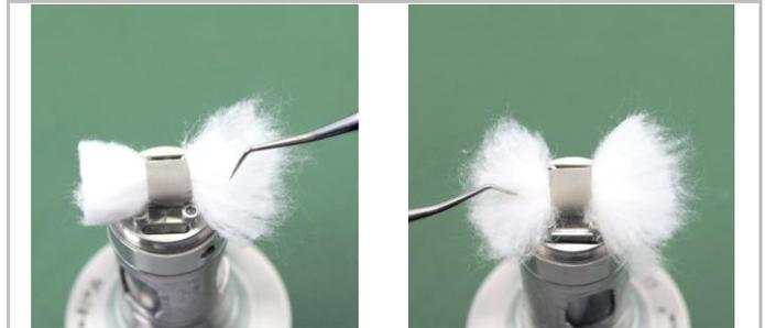
Die Enden der Watte werden nun mit einer Pinzette etwas ausgedünnt.
