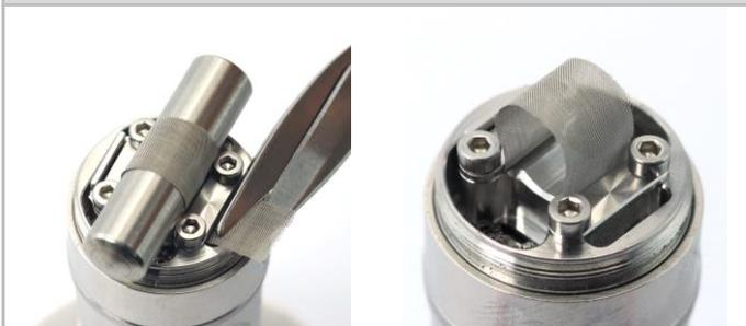
Nun wird das überstehende Mesh abgeschnitten und die Wickelhilfe [Y] entfernt. Das verbleibende Mesh bildet nun einen Bogen
