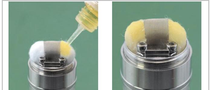
Anschließend wird die Watte mit etwas Liquid getränkt.
