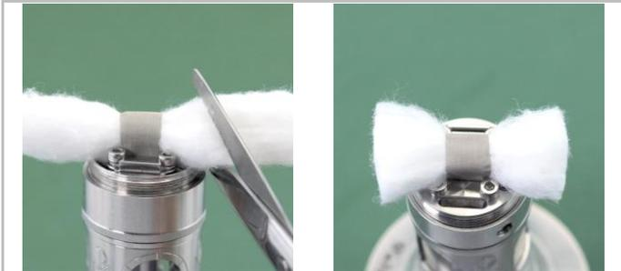
Anschließend wird die Watte beidseitig zurechtgeschnitten..
