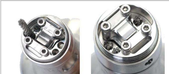
Die Dochte [X] im Uhrzeigersinn in das Deck [E] drehen. Dabei sollte kein übermäßiger Druck ausgeübt werden.
