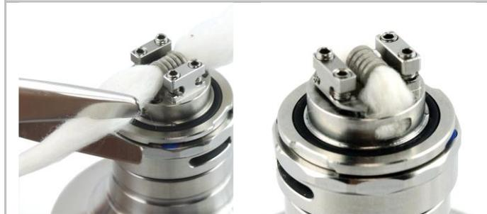
Die Watte wird beidseitig eingekürzt. Die Enden der Watte können nun in die seitlichen Taschen gelegt (nicht gestopft) werden. Die Öffnungen für das Liquid sollten jetzt von innen heraus vollständig mit Watte bedeckt sein.
