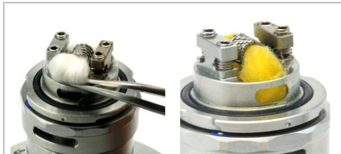
Man kann die Watte auch leicht einrollen, um sicher zu stellen, dass die Kanäle vollständig verdeckt sind. Zur Kontrolle die Watte anschließend mit etwas Liquid tränken.
