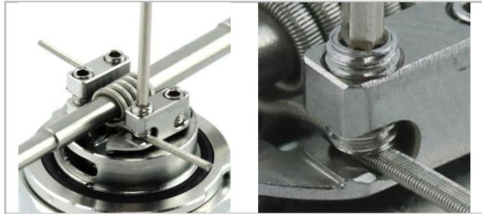
Die beiden Enden der Wicklung sollten dabei direkt unterhalb der gelösten Schrauben positioniert werden.
