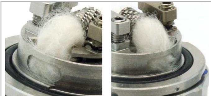
Bitte drauf achten, dass die Watte vollständig den Kanal bedeckt, da ansonsten beim Befüllen Liquid in die Kammer gelangen kann.
