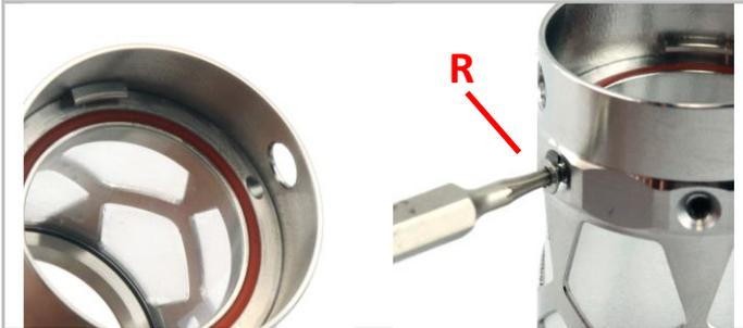
Der Tank-Ring [M] wird zunächst mit einer einzelnen Senkschraube [R] fixiert.
