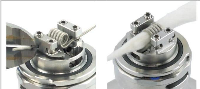
Die überstehenden Drahtenden werden mit einem geeigneten Werkzeug entfernt.
