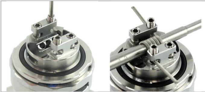
Zunächst werden die beiden benötigten Befestigungsschrauben mit dem Innensechskantschlüssel ein wenig gelöst.
